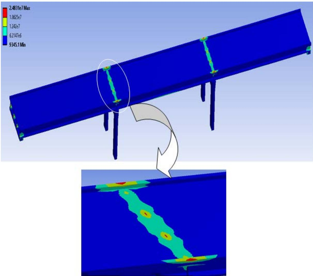
FIGURE 7: MAXIMUM STRESSES AT THE DECK JOINT DUE TO A TYPICAL EARTHQUAKE
