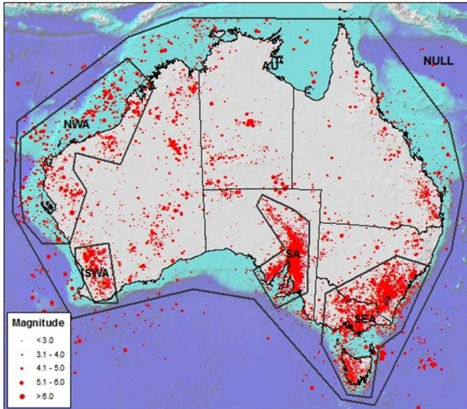
FIGURE 6: EARTHQUAKE CATALOGUE AND SEISMIC SOURCE ZONES. LEONARD (2008).
