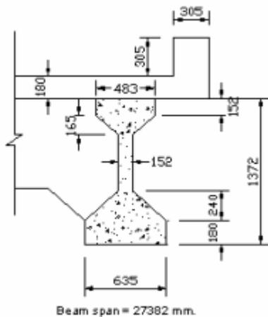
FIGURE 2: SECTION DETAIL OF PRE-CAST CONCRETE BEAM (SETUNGE ET AL., 2002)
