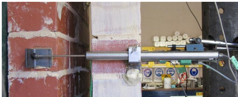
(d) LVDT to monitor changes in the gap
